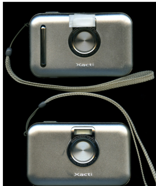
Abb. 1: Abgeklebter Blitz bei der E60 (unten E6)
